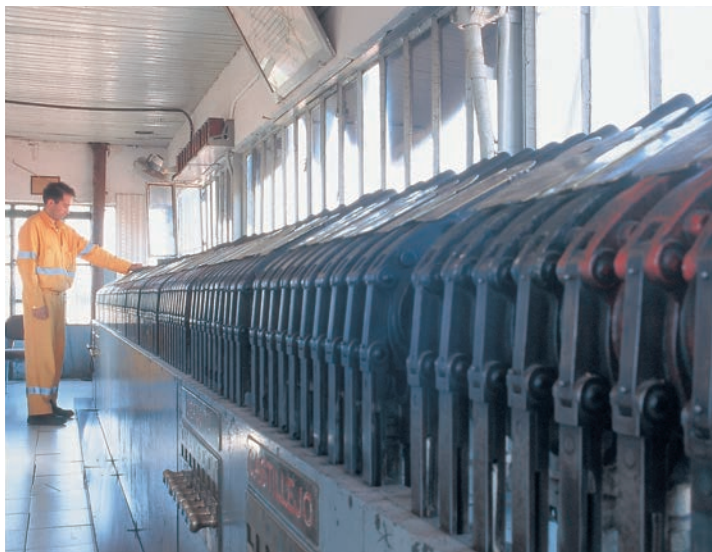
Mesa de concentración de palancas.
