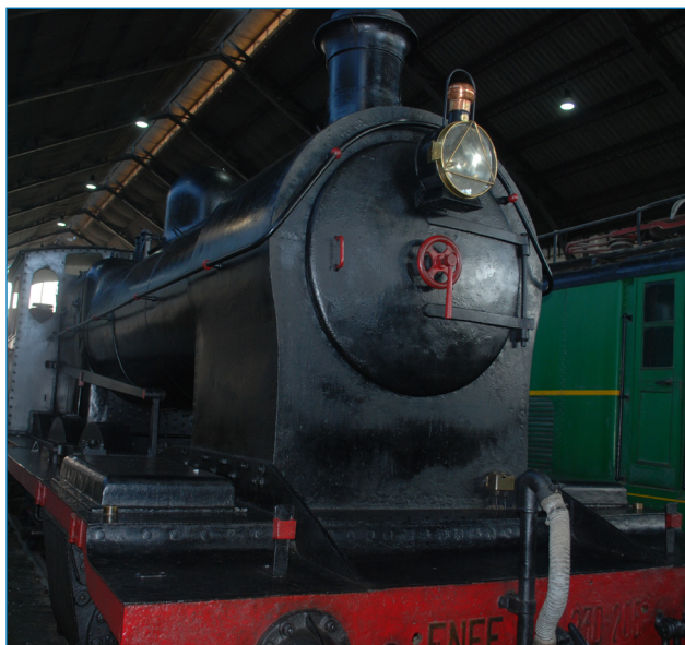
Figura 9. Locomotora en que aprecia el proyector de acetileno y el tubo de conexión del aire comprimido para los frenos. Foto. JAMP 02/05/2018
