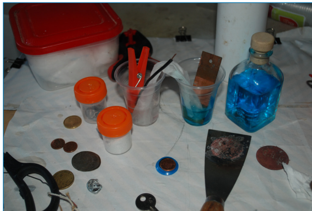
Figura 13. Se observa la marca de corrosión producida en unos 10 min. sobre la espátula de acero. Foto: JAMP 10/2019
